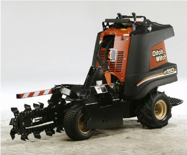
**Macchina compatta dotata di un telaio articolato per eseguire trincee curve.**
